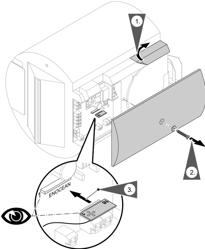
Zusammenbau und Einbau in die Wandhülse: Arbeitsschritte 1. bis 3. in umgekehrter Reihenfolge
