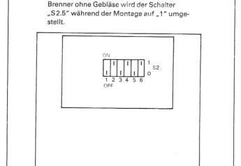
Abb. 2 Schalter "S2." auf der Rückseite der Elektronikbox im Anlieferungszustand
