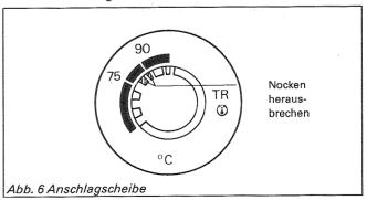
**4.** Drehknopf "TR ©" so einbauen, daß sich die Markierung zwischen "75" und "90" befindet.
