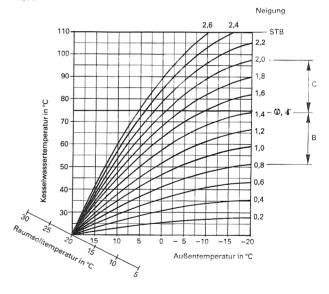
Diese Darstellung der Heizkennlinien (Richtwerte für mittlere Kesselwassertemperatur) gilt, wenn:
