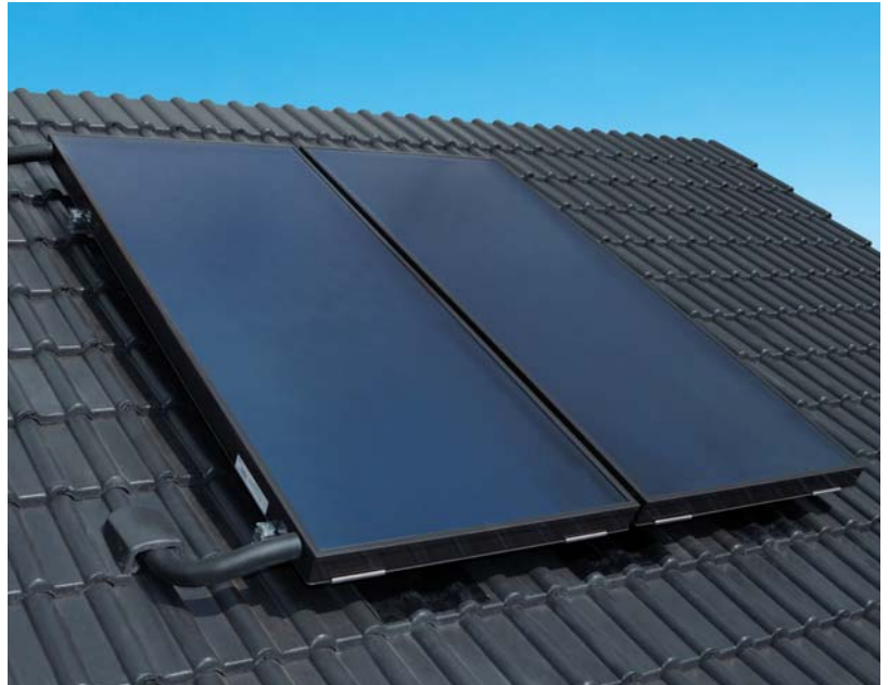
Der Flachkollektor Vitosol 200-F mit innovativer schaltender Absorberbeschichtung unterbricht bei Stagnation die Energieaufnahme.
