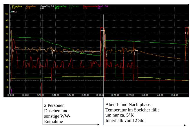
Fazit: Endlich ist der Beweis erbracht, dass die eingebaute Zirku-Pumpe "E1vario-13/10V BQ" entweder kein Rückschlagventil besitzt, oder das Rückschlagventil ist defekt.
