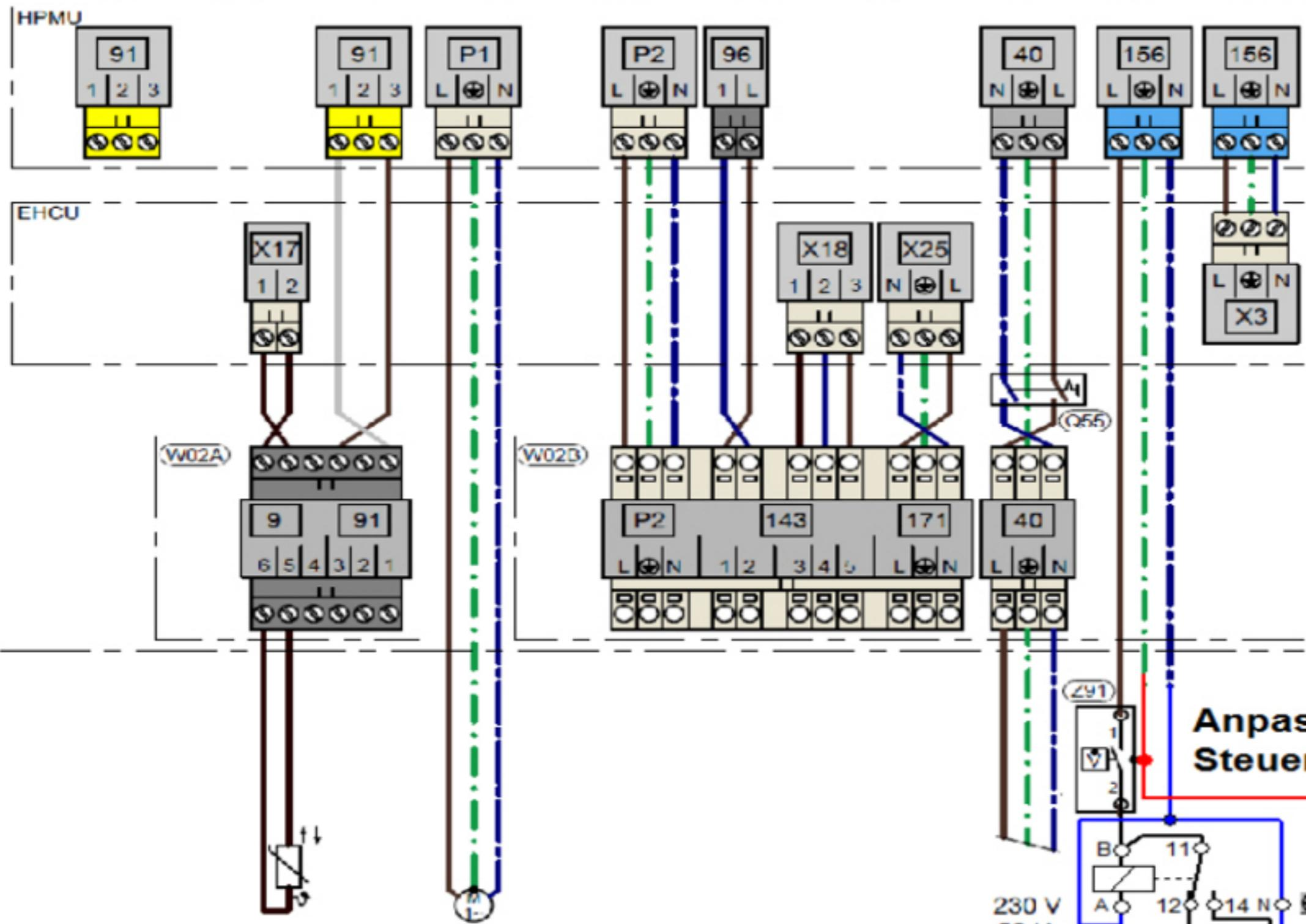
**Anpassung für Steuerung Umschaltventil**
