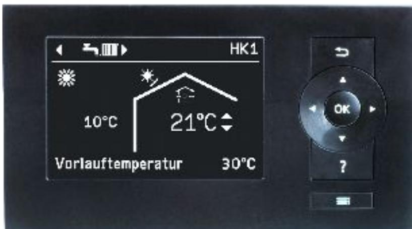
Abb.1: Display Wärmepumpenregelung Vitotronic 200
