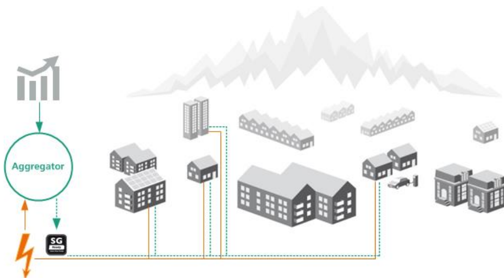
Abbildung 89: Aggregator kann über SG-Ready direkt Wärmepumpen ansteuern.
