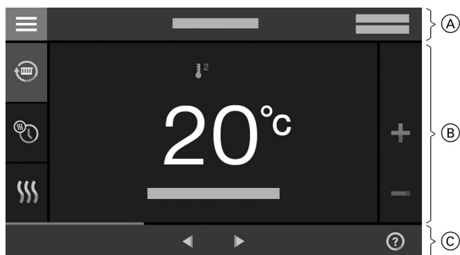
Abb. 5 Beispiel: Witterungsgeführter Betrieb
