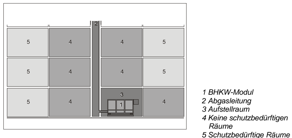
Abb. 3 Beispielhafte Anordnung vom Aufstellraum des BHKW-Moduls und den angrenzenden Räumen in einem Gebäude
